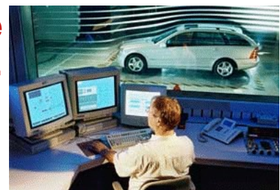
Essai en soufflerie d'une Mercedes Classe C
