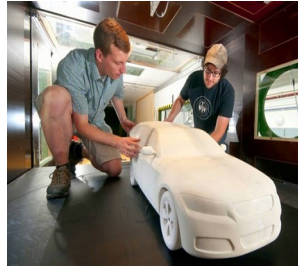
Réalisation de maquettes en plastiline (glaise synthétique) ou avec une imprimante 3D
